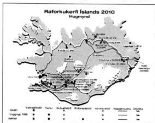
Mögulegt raforkukerfi landsins árið 2010. Ein 400 kV rafliða nægir á milli Norður- og Austurlands.
